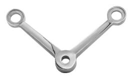
Допустимая осевая нагрузка на плечо (обратная ветровой нагрузке) – 2100Н. Радиальная нагрузка, вызываемая весом стекла – 1000H
